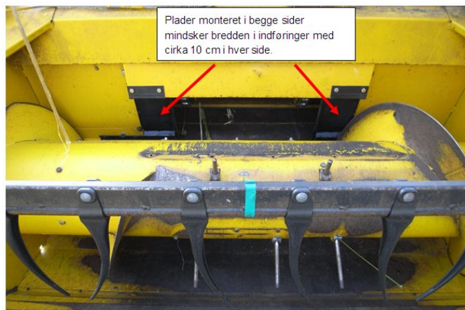
Foto 16. Der er monteret plader i begge sider af indføringen for at hindre, at hampestænglerne vikler om kæder og aksler i indføringen og tærscopylinder. Fotograf: Lars Egelund Olsen, Videncentret for Landbrug.
